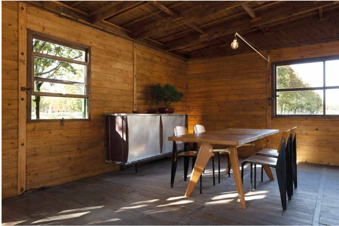
La maison préfabriquée BCC F 8×8, dite chalet Jeanneret-Prouvé, est une petite construction démontable tout bois, produite entre 1941 et 1943. Sur 64m², l'espace fluide s'organise autour d'un « coin feu » structuré par un portique central apparent, avec cloisons coulissantes et terrasse couverte prolongeant le séjour.
